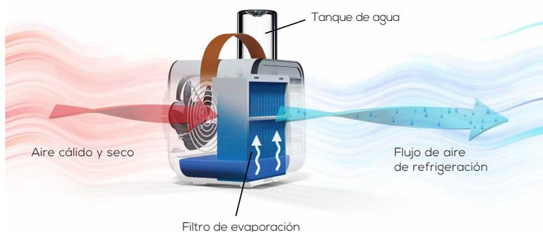
El ventilador de aire aspira el aire seco y cálido de la habitación, que luego entra en contacto con el filtro de evaporación, el cual está saturado con agua. El contacto entre el flujo de aire y la superficie húmeda del filtro provoca la evaporación del agua. El aire del ambiente absorbe la humedad, y la energía térmica requerida para el proceso de evaporación se extrae del aire del ambiente. Hay una caída notable en la temperatura del aire del ambiente.
