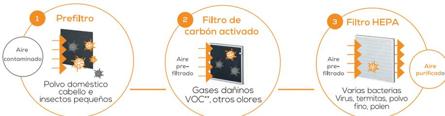
Principio de funcionamiento del purificador de aire: el polvo doméstico, los pelos de animales, los olores, el polen, los gases nocivos y diversas bacterias y virus se filtran del aire mediante un sistema de filtrado de triple capa.
